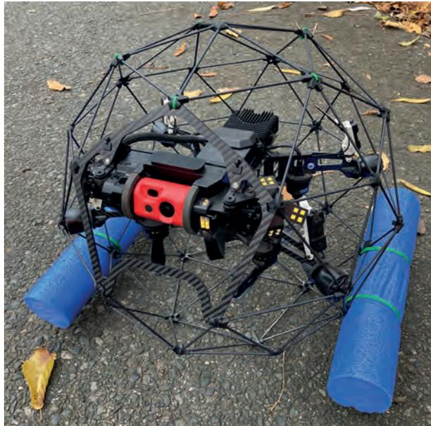
Der für die Inspektion eingesetzte Multicopter. (Foto: SUN).
